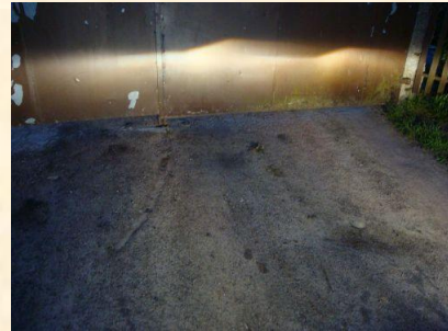
Rozproszenie światła od chropowatej powierzchni drogi „złudzenie świecącego się ośrodka”.
